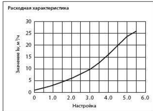
Диаграмма для подбора настройки клапана типа MSV-BD Ду = 40 мм
